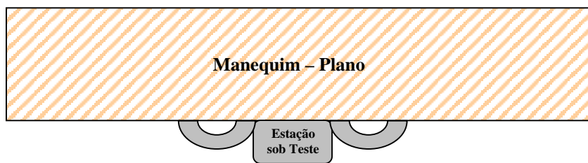
Figura 11 – Representação esquemática do posicionamento de uma Estação sob Teste para uso em outros membros.
