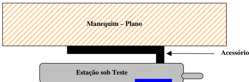
Figura 7 – Representação esquemática do posicionamento da Estação sob Teste com acessórios definidos.
