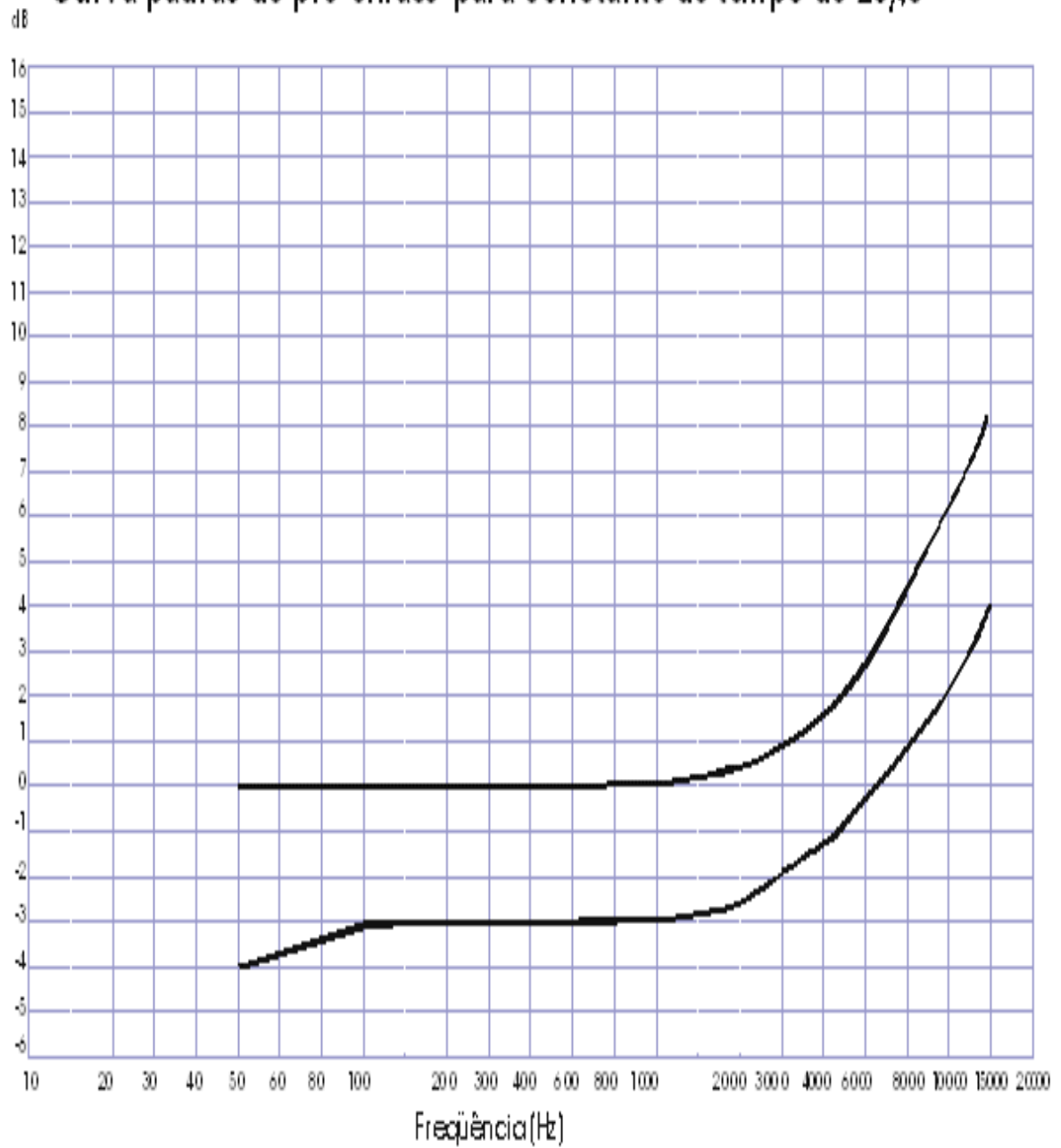
Curva padrão de pré-ênfase para constante de tempo de 25 \mu s
